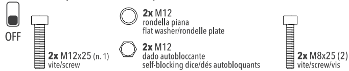
fig. A Minuteria consigliata per l'installazione/ Small parts recommended for installation/ Petites pièces recommandées pour l'installation
